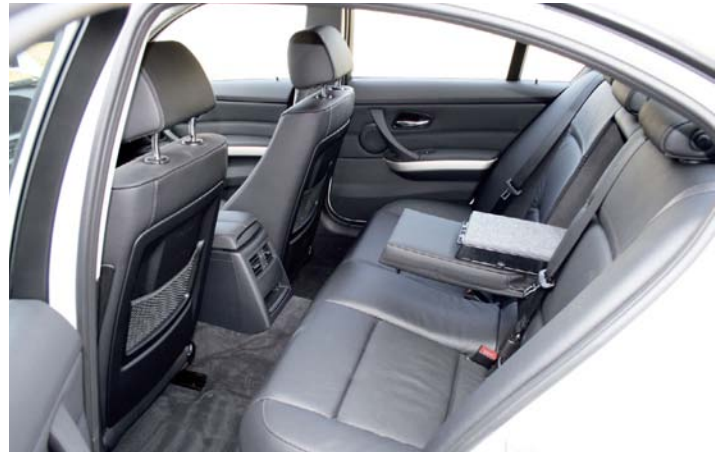
Über der Mittelarmlehne in der Fondbank des BMW 320d gibt es weiterhin eine praktische Durchlademöglichkeit mit Skisack.
