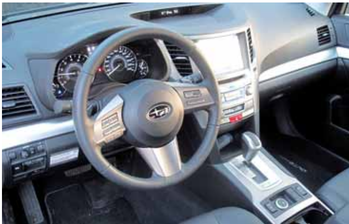
Im fahrerorientiert und übersichtlich gestalteten Outback-Cockpit sitzt der Autogas-Schalter mit den Anzeige-LEDs in der Mittelkonsole hinter dem Getriebe-Wählhebel.
