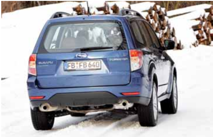
Üppige 21,5 Zentimeter Bodenfreiheit und zusätzliche Low-Range-Geländeunterstützung erlauben dem Forester anspruchsvolle Off-Road-Einsätze.
