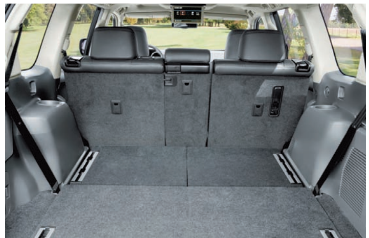
Die zweite, in Längsrichtung einstellbare Sitzreihe des Land Cruiser hat eine im Verhältnis 40:20:40 geteilt umklappbare und in der Neigung einstellbare Rückenlehne.
