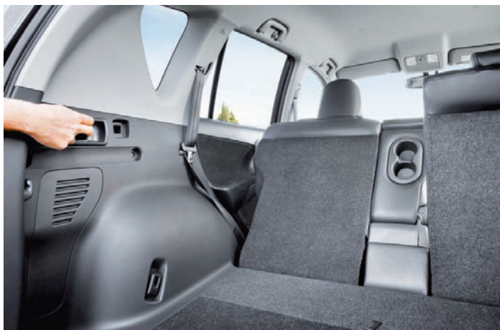
Mit je einem Handgriff lassen sich die asymmetrischen Teile der dreiteiligen Fond-Rückenlehne im RAV4 bequem von der Hecköffnung aus umklappen.
