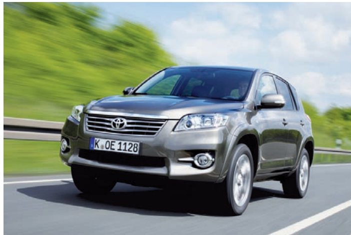
Kühlergrill mit Chromleiste, Projektionsleuchten für das Abblendlicht und Frontstoßfänger mit integrierten Nebelscheinwerfern prägen den Bug des RAV4
